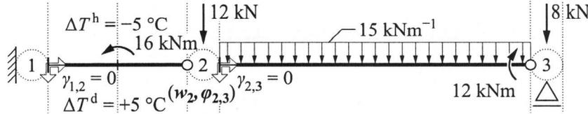
Stupeň přetvárné neurčitosti (1.6)  $n_p = 2$  (neznámé parametry  $w_2, \varphi_{2,3}$ )
