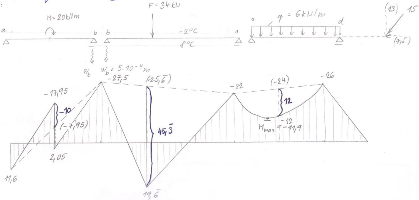
K PRŮBĚHU (M): 1) Výšku základní hodnoty nadpodporových momentů  $M_a, M_b, M_c$  + průběh (M) na převlékém konci
